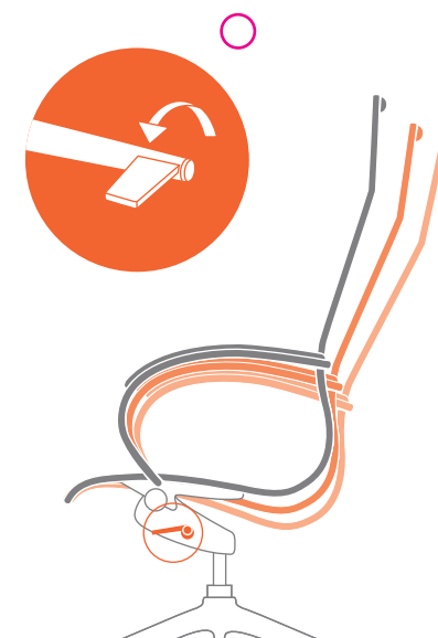
Regolazione inclinazione dello schienale Adjusting backrest tilting Réglage de l'inclinaison du dossier Einstellung der Rückenlehnenneigung Ajuste de la inclinación del respaldo
